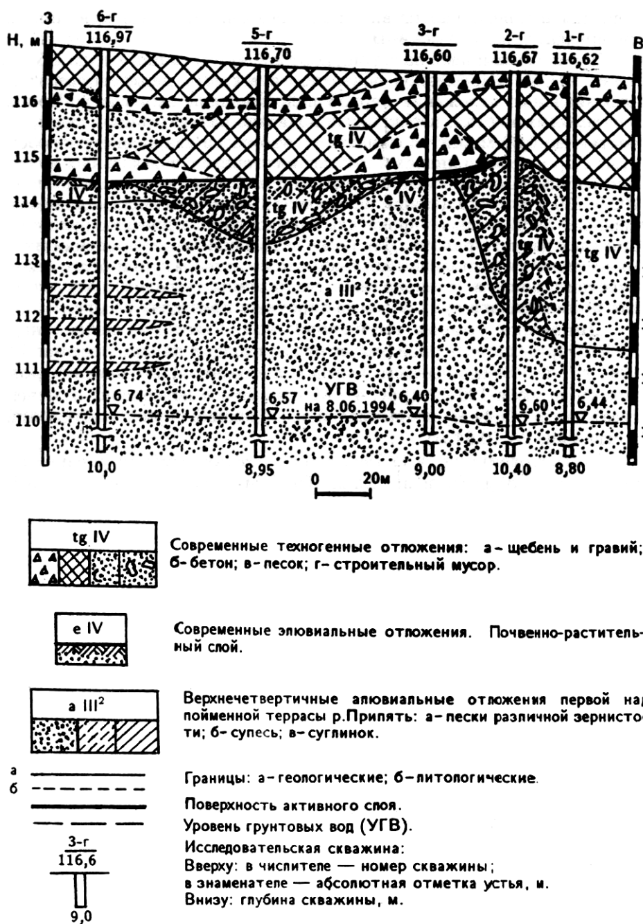
Рис. 2. Геолого-литологический разрез по линии 6-г - 1-г
