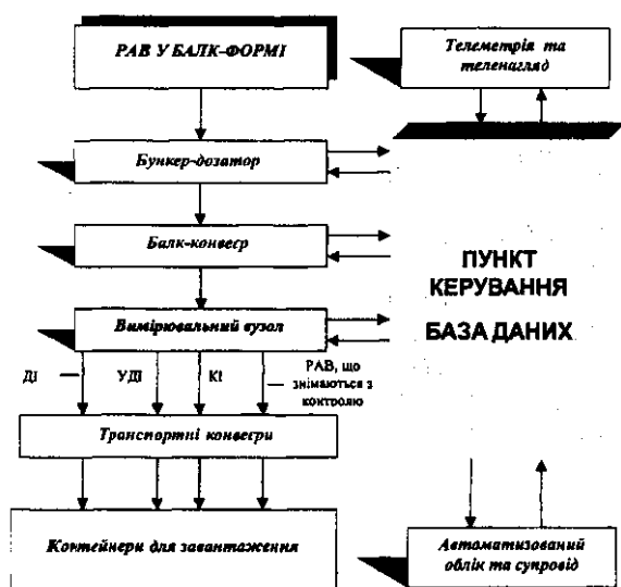
Рис. 1. Структурна схема системи конвеєрного сортування РАВ у балк-формі за активністю
