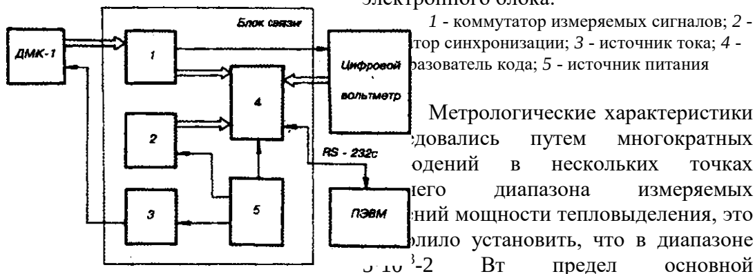
Рис. 5. Функциональная схема электронного блока:
