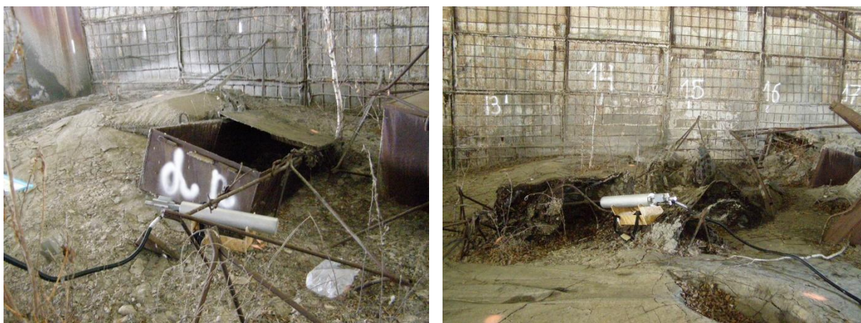
Рис. 9. Измерение нейтронных потоков на поверхности модуля Б-1 [3]
