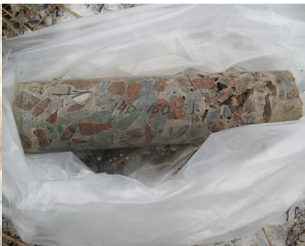
Рис. 22. На фото слева – скважина X10: хорошо виден слой специального бетона. На фото справа – бетонный керн, извлеченный из скважины [4]
