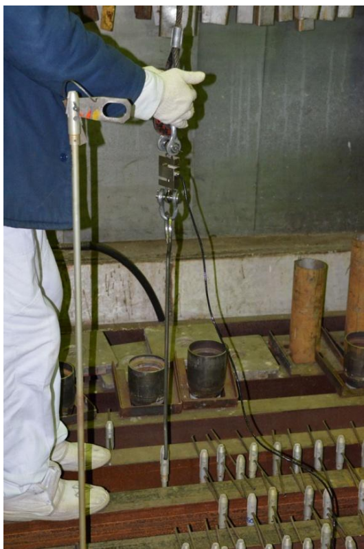
Рис. 7. Робочі моменти зважування контрольного вантажу над «сухою» шахтою ЦЗ-2 на початку та кінці зміни
