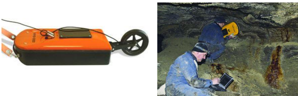
Рис. 8. Георадар VIY-3 («Transient technologies», Украина) с антенным блоком 300 МГц
