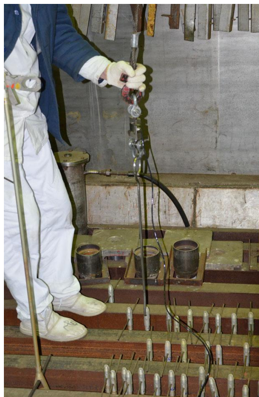
Рис. 7. Робочі моменти зважування контрольного вантажу над «сухою» шахтою ЦЗ-2 на початку та кінці зміни
