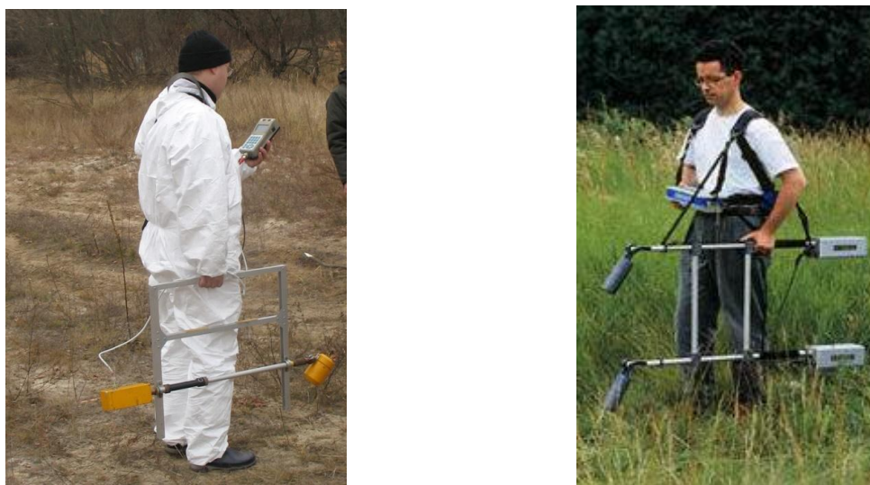
Рис. 5. Магнитометры ПКМ-1(Россия) – на фото слева, измерения на ПЗРО «3-я очередь ЧАЭС» и «SmartMag SM-4», Канада – на фото справа
