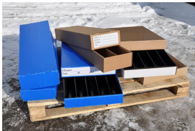
Рис. 25. На фото слева – укладка керна в пластиковые трубы и ящики, на фото справа – ящики, выпускаемые промышленностью
