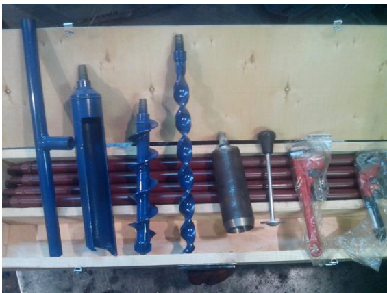
Рис. 10. Комплект ручных буров геолога
