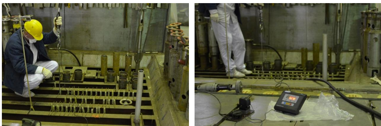
Рис. 6. Відпрацювання технології зважування довгомірів у центральному залі блоку № 2 ЧАЕС. На фото справа – вимірювальний термінал ІЕ-03
