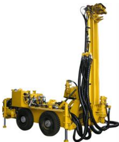
Рис. 23. Передвижные буровые установки. На фото слева – передвижной малогабаритный буровой станок «Сугомак М-200», на фото справа – многофункциональная буровая установка «Figaro Maschine FM T400»
