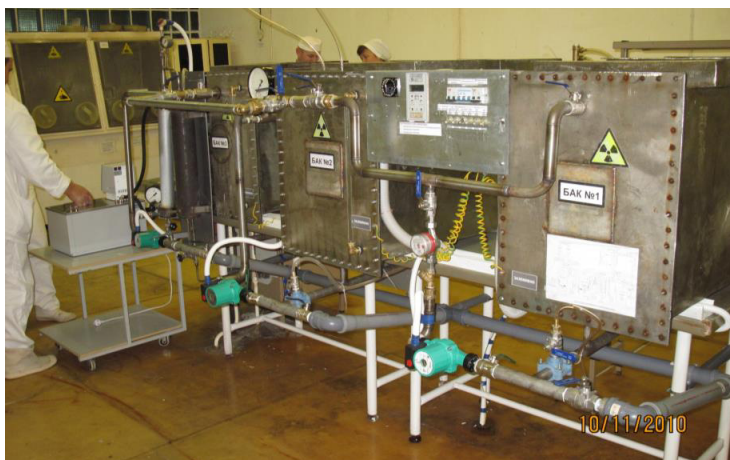
Рис. 18. Пилотная установка по очистке ЖРО от ТУЭ и органики
