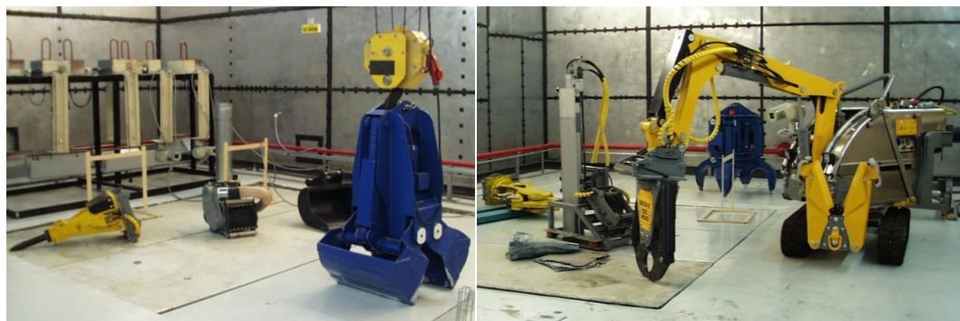
Рис. 9. УИТО. Оборудование для обращения с ТРО
