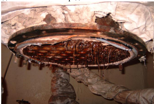
Рис. 3. Выпарной аппарат, вышедший из строя из-за полимеризации органической эмульсии
