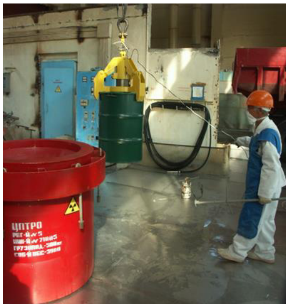
Рис. 15. Загрузка 200-литровой бочки с ВАО в контейнер КТЗВ-0,2
