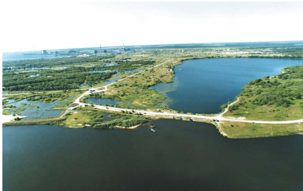
В зоні відчуження проведено низку водоохоронних заходів. Серед них – будівництво захисних дамб в заплаві ріки Прип'ять. Це суттєво зменшило змив радіонуклідів з найбільш забруднених ділянок заплави ріки під час весняних повеней.
